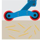
Тандемное расположение барабанов обеспечивает работу агрегата без забивания.
