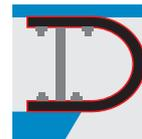
Крепление батарей катков через С-образные стойки к раме предохраняет раму катка от повреждений.
