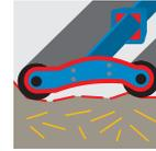
Копирование микрорельефа поля двойными катками-измельчителями обеспечивается благодаря маятниковому креплению с резиновыми демпферами.
