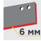
Стойки ножи толщиной 6 мм выполнены из стали 30MnB5 с термообработкой.
