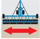
Равномерное давление на рабочие органы по всей ширине захвата достигается благодаря рамной конструкции, в следствии чего происходит однородная обработка.
